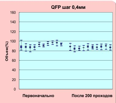
Специально разработанные лубриканты обеспечивают хорошее отделение пасты от трафарета в течение длительного времени, что позволяет использовать пасту для монтажа micro-BGA.
